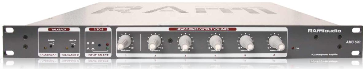
L'**AMC620** est un boîtier amplificateur pour six casques, avec possibilité de déporter les commandes de volume.
