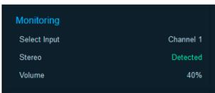
**Select Input :** Canal MPX démodulé sélectionné vers la sortie Jack en face avant et le connecteur «M» en face arrière de l'appareil.
